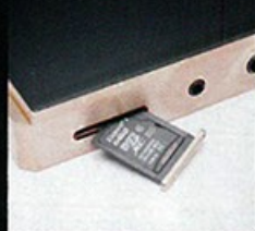
■機頂插槽只容得下一張 MicroSD 記憶卡，最高支援 256GB。
